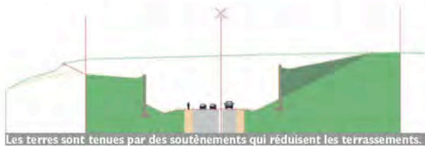
Les terres sont tenues par des soutènements qui réduisent les terrassements.
